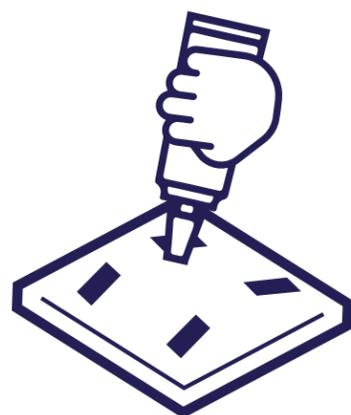
Los paneles pueden fijarse a pared con algún adhesivo en base silicón, o pegamento de contacto, poniendo un poco del adhesivo en las esquinas y centro del mismo.
