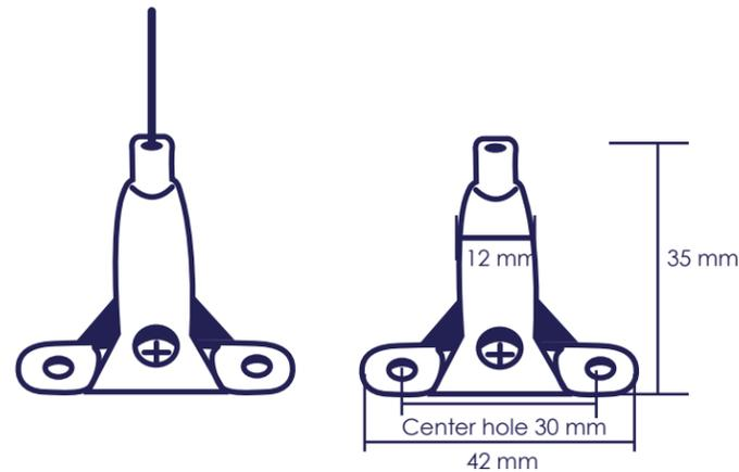
Se utilizan este tipo de accesorios, el cual va atornillado al techo y al panel respectivamente.
